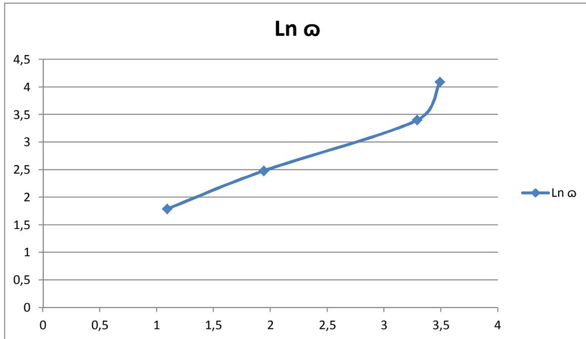
Viscosité constante ou qui ne peut varier qu'en fonction de la température, donc le fluide analysé est newtonien.
