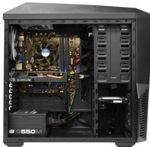
Figure 2. Composants internes d'un ordinateur.
