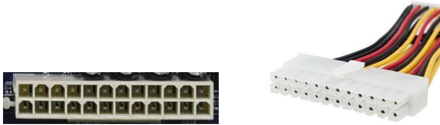
Figure 3. Connecteur ATX 20/24 broches
