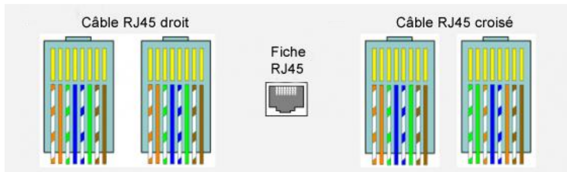
Figure 10. Câble RJ45 droit et câble RJ45 croisé.
