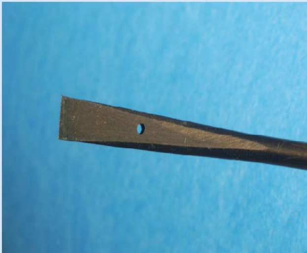
sonde de pression statique de type GG
