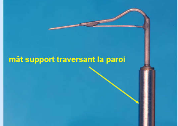
sonde Pitot avec raidisseur pour exploration de couche limite
