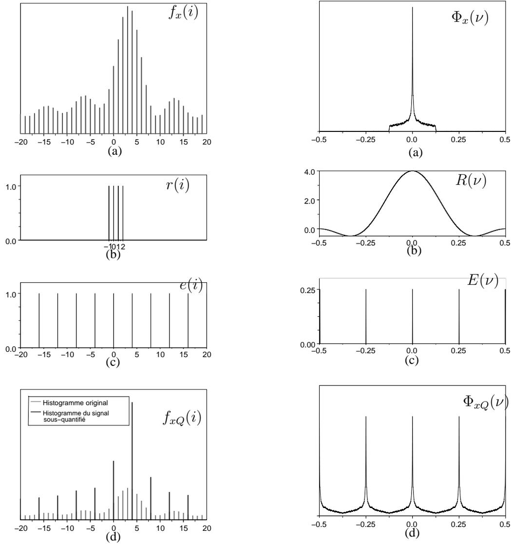
FIGURE 4 – Echantillonnage de surface : (a) histogramme original  $f_x(i)$  ; (b) filtre rectangulaire  $r(i)$  ; (c) train d'impulsions  $e(i)$  ; (d) histogramme du signal sous-quantifié  $f_{xQ}(i)$
