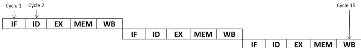
L'exécution de trois instructions dans un ordinateur sans pipeline nécessite 15 cycles
