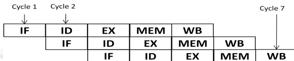
L'exécution de trois instructions dans un ordinateur avec un traitement pipeline nécessite seulement 7 cycles.
