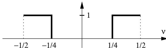
FIG. 3 – Réponse fréquentielle idéale
