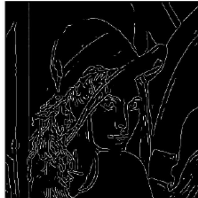
Contours (norme du gradient, seuillé et aminci)
