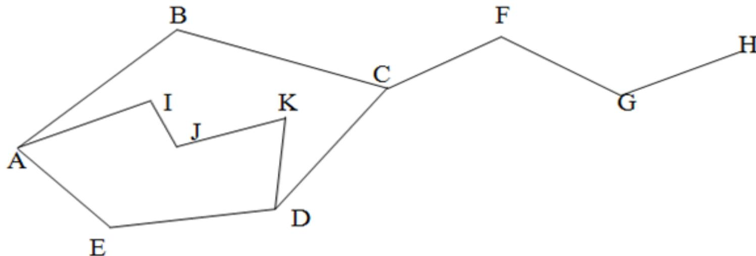
1. Polygonale fermée (ABCDEA) : lorsque la fin du cheminement se termine sur le point de départ. Dans ce cas on peut vérifier la mesure des angles intérieurs par :
