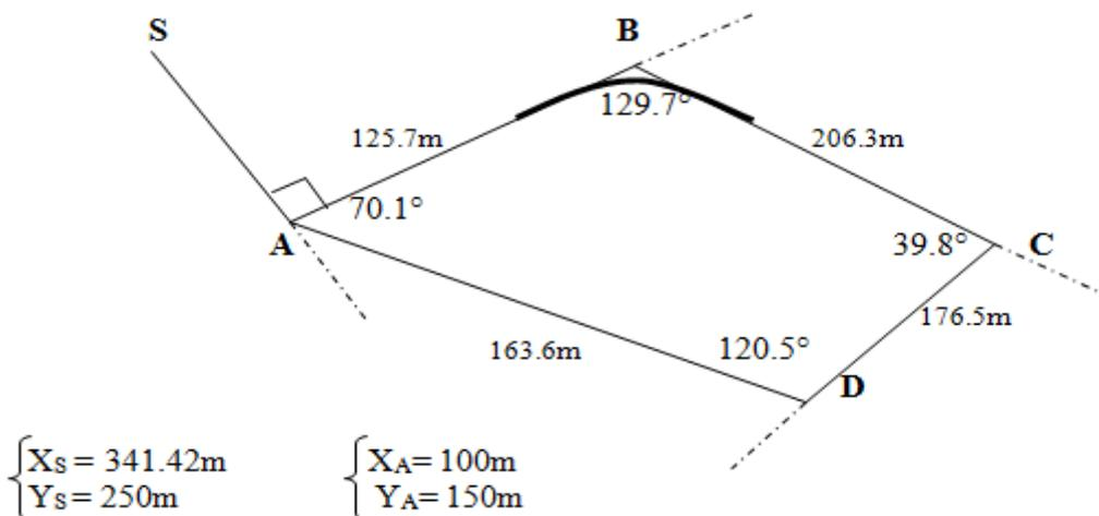
On désire raccorder les 2 alignements horizontaux AB et BC par une courbe circulaire simple tangente à la droite EF en M. (EF = 129.5m)
