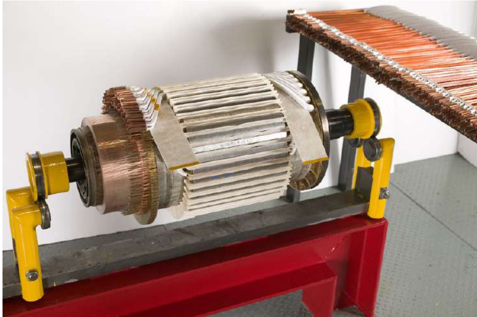
FIGURE 3.9 – Mise en place des conducteurs d'induit dans les encoches et soudure de ceux-ci sur le collecteur.
