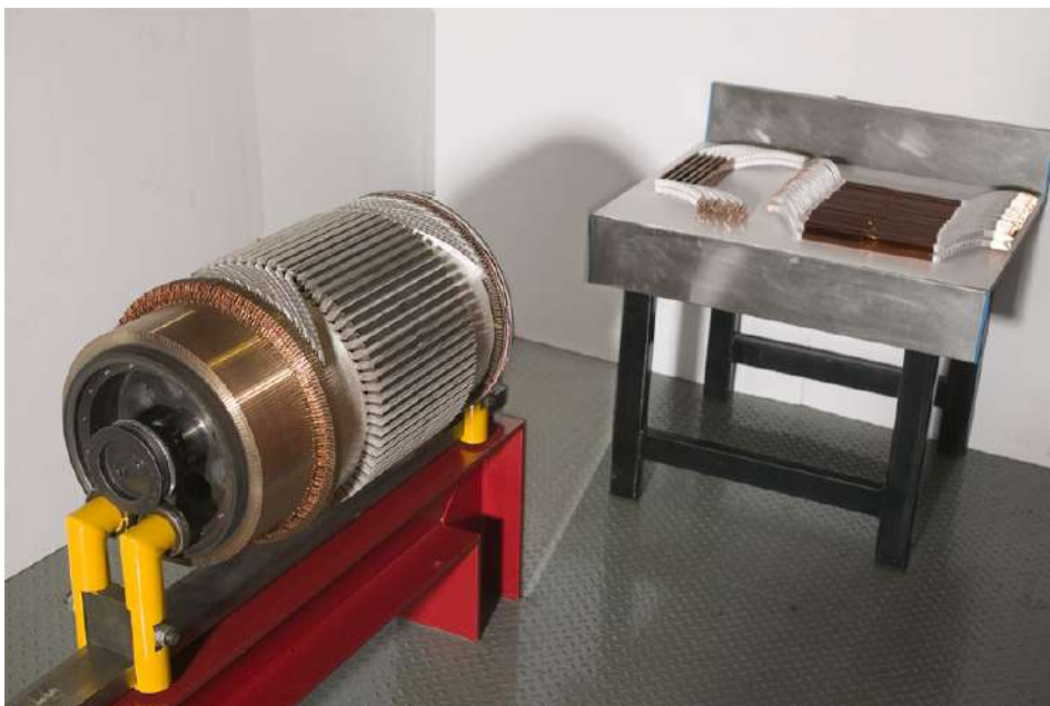
FIGURE 3.8 – Mise en place des conducteurs d'induit dans les encoche et soudure de ceux-ci sur le collecteur.
