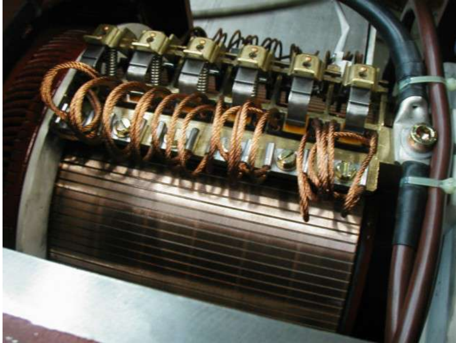
FIGURE 3.14 – Détails de la ligne des balais d'une machine à courant continu de forte puissance.
