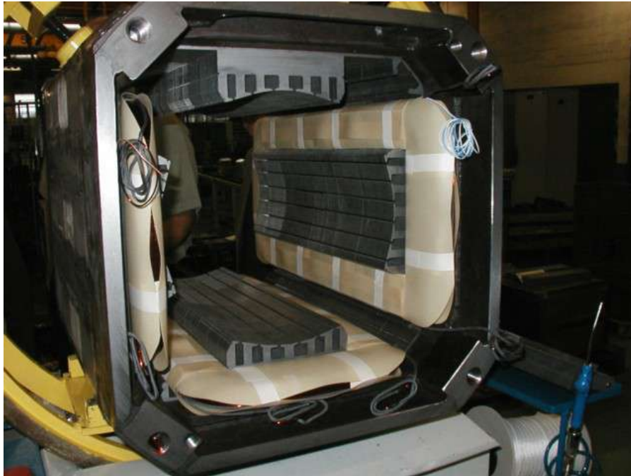
FIGURE 3.5 – mise en place des bobines sur le circuit magnétique statorique d'une machine à courant continu.
