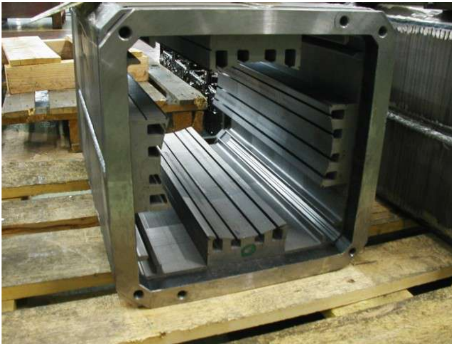
FIGURE 3.3 – Culasse, circuit magnétique statorique d’une machine à courant continu.
