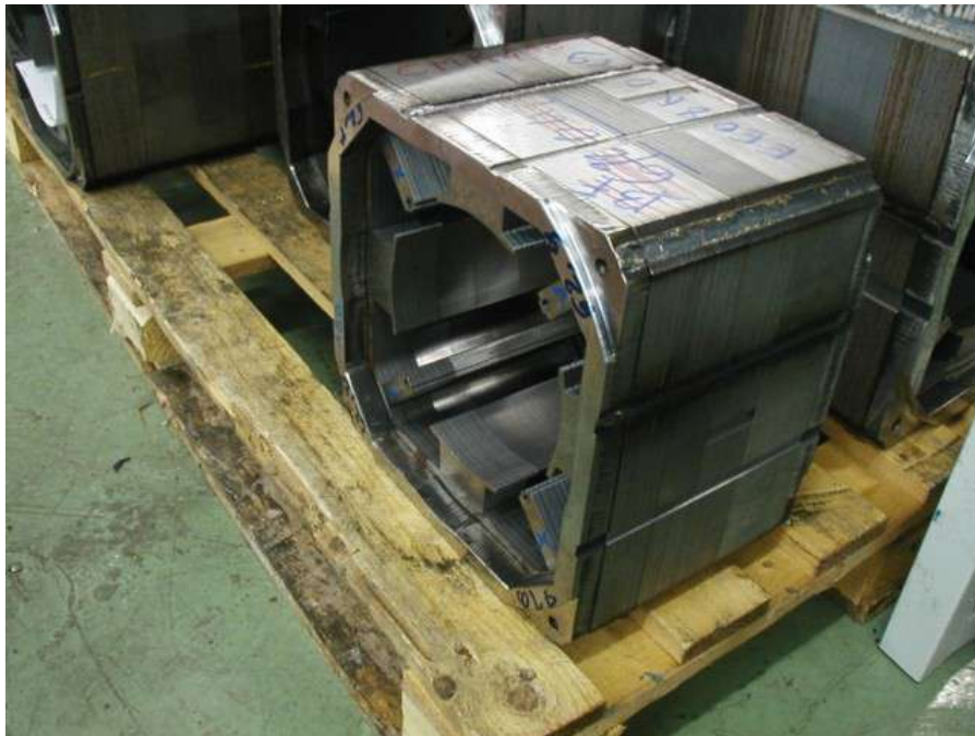
FIGURE 3.4 – Culasse, circuit magnétique statorique d'une machine à courant continu.
