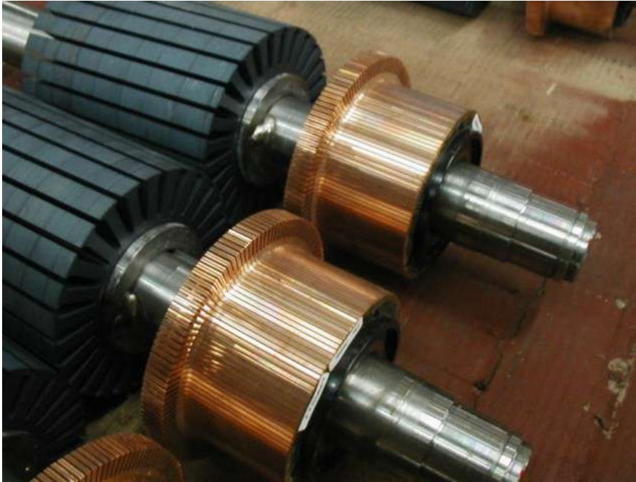
FIGURE 3.12 – Collecteur d’une machine à courant continu de forte puissance.
