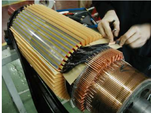
FIGURE 3.7 – Mise en place des conducteurs d'induit dans les encoche et soudure de ceux-ci sur le collecteur.
