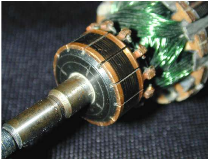
FIGURE 3.11 – Collecteur d'une machine à courant continu de faible puissance.
