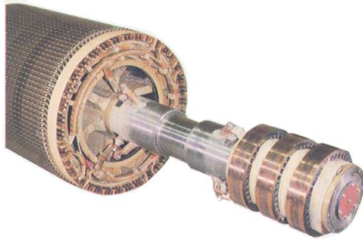
FIGURE 5.4 – les trois bagues de l'arbre moteur d'une machine asynchrone à rotor bobiné.
