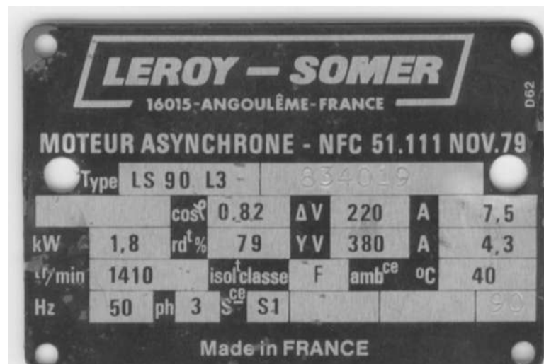
FIGURE 2.2 – Plaque signalétique d'une machine asynchrone.
