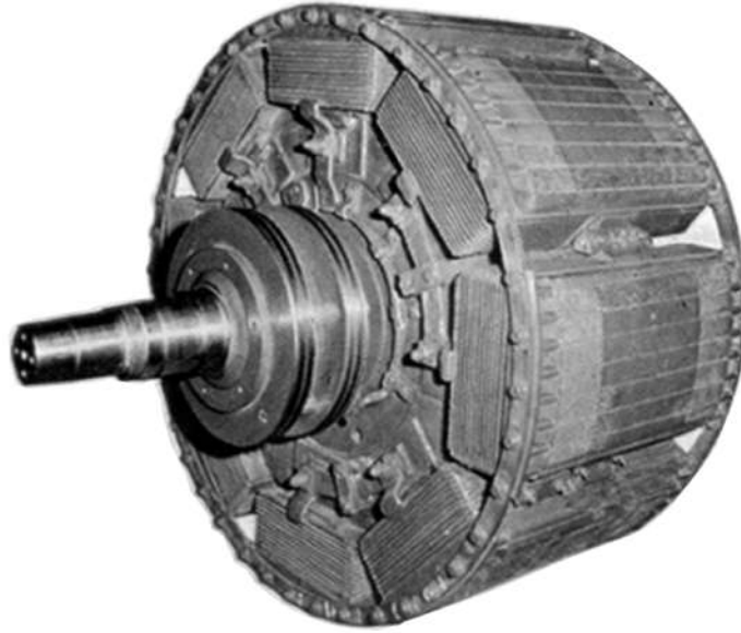
FIGURE 4.13 – rotor d'un moteur de locomotive BB 15055 de puissance 5,6 MW, on distingue les bagues permettant l'injection du courant continu.
