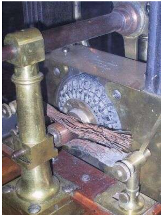
FIGURE 3.13 – Balais des premières machines à courant continu.
