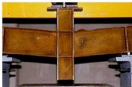
Figure I. 9: Voilement local de la membrure de l'âme supérieure[6].
