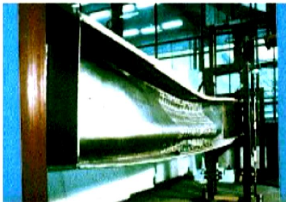
Figure I. 8: Phénomène de voilement total de l'âme [6].
