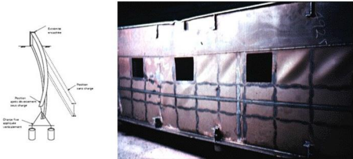
Figure I. 10: Phénomène de déversement des poutres[6].
