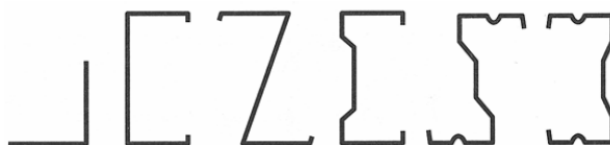
Figure 1-5 Produits longs formés à froid Exemples de sections transversales Bardage
