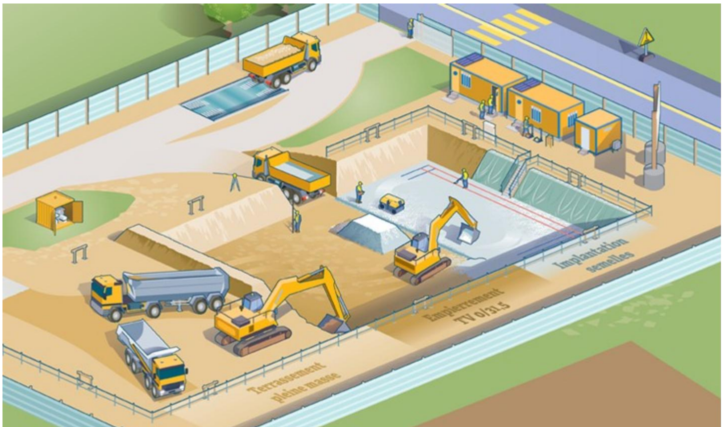
Figure 1.3.Exemple d'un chantier de terrassement
