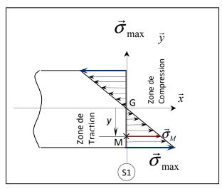
Figure 6.4: Répartition des contraintes dans une section droite.
