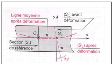
Figure 6.3: Définition de l'angle  $\Delta \phi$ .
