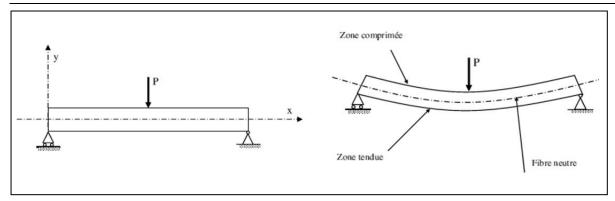
Figure 6.2: Modélisation d'un essai de flexion trois points.
