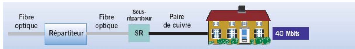
Figure 6. Structure d'un réseau FTTC/FTTCab.
