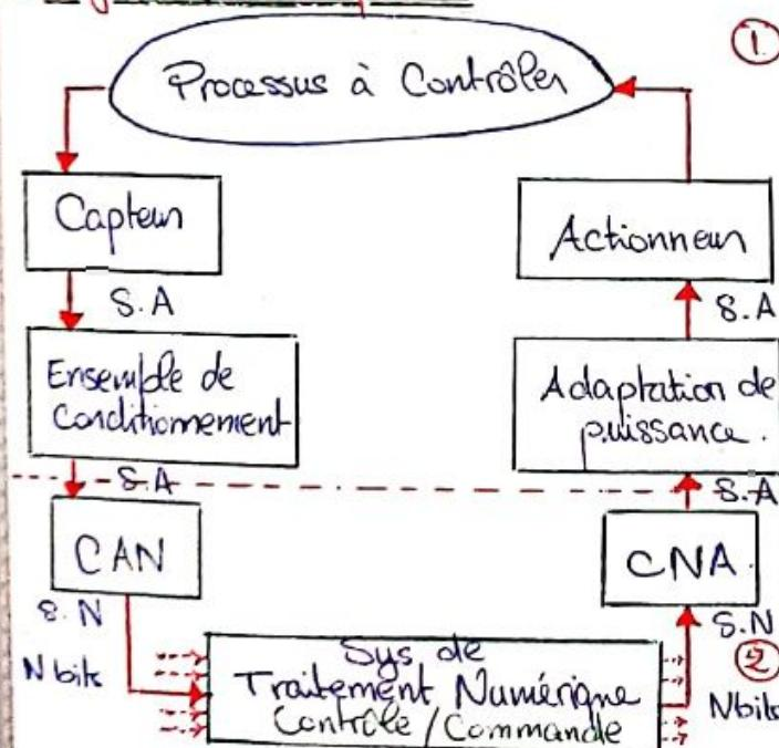
\* Processus à contrôler : grandeur physique (mouvement mécanique, variation de température, ...)
