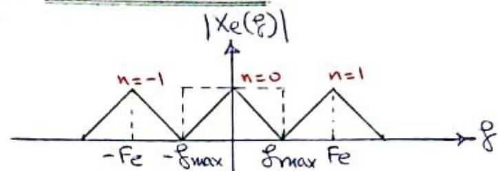
→ on peut récupérer le spectre  $X(f)$  par le filtrage (un filtre idéal passe bas) et reconstruire le signal initial  $u(t)$  à partir de la connaissance de son échantillonage  $x_e(t)$ .
