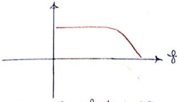
→ En pratique, la réalisation du filtre idéal est impossible, pour approcher à cette réponse idéale on définit un gabarit et en précisant :
