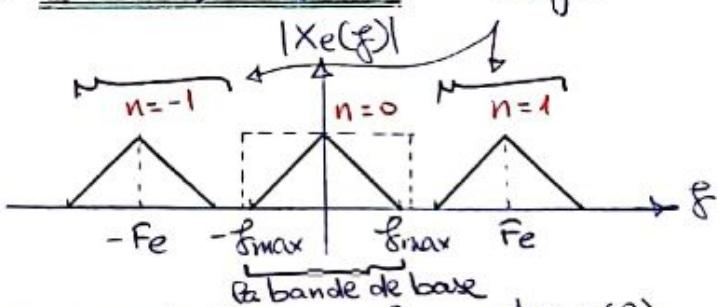
→ on peut récupérer le spectre  $X(f)$  par le filtrage, et reconstruire le signal initial  $u(t)$ . [pas de recouvrement].
