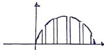
→ Pour se rapprocher d'un échantillonage idéal et qu'ainsi le signal soit facilement reconstruisible, il faut que " $\tau$ " soit le plus petit possible.
