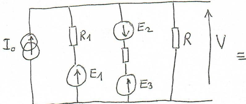
La source de -courant va être transformée en une source de tension
