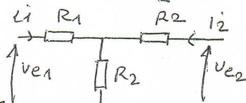
$$= \begin{bmatrix} 1 & R_1 \\ 0 & 1 \end{bmatrix} \begin{bmatrix} 1 & 0 \\ \frac{1}{R_2} & 1 \end{bmatrix} \begin{bmatrix} 1 & R_1 \\ 0 & 1 \end{bmatrix}$$
