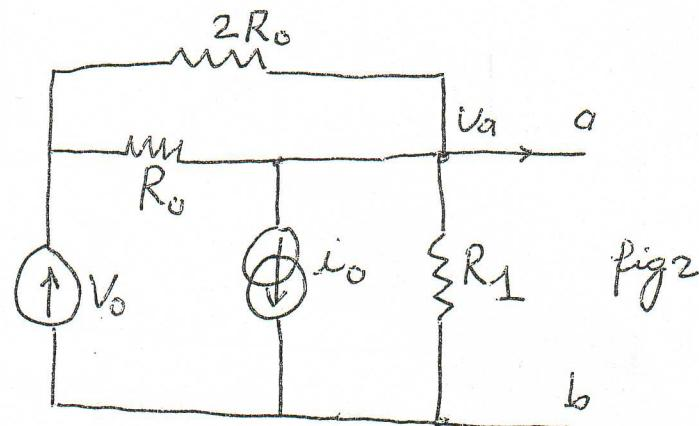
En utilisant les transformations générateur de tension et de courant on aura
