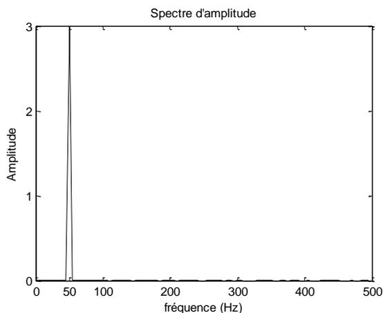
On Remarque bien le pic d'amplitude 3 autour de la fréquence 50 Hz ce qui traduit effectivement l'information fréquentielle contenue dans le signal étudié.
