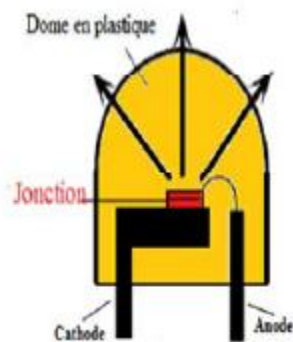
Figure 3.2 : Structure de base d'une diode électroluminescente " DEL " [11]
