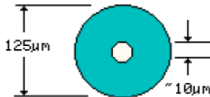
Figure 2.7 : les dimensions cœur/gaine d'une FO monomode [10]
