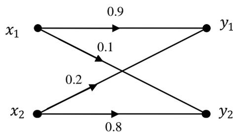
Figure. III.3 : Schéma d'un canal de communication binaire
