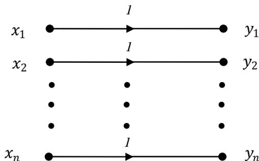
Figure. III.4 : Schéma d'un canal de transmission sans bruit
