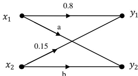
Figure III.T1 : Schéma d'un canal de transmission binaire
