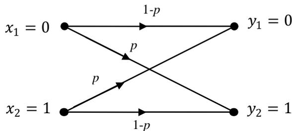
Figure. III.5 : Schéma d'un canal de transmission binaire symétrique
