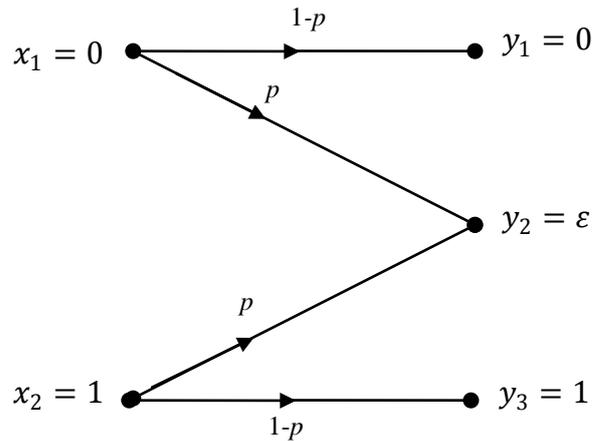
Figure. III.7 : Schéma d'un canal de transmission binaire à effacement
