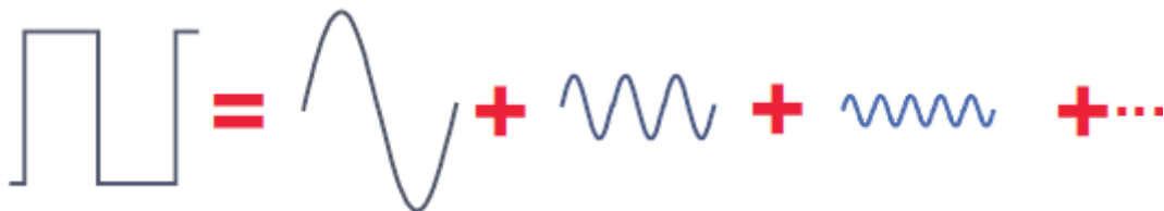
Figure II.3 – Décomposition d'un signal carré symétrique par rapport au 0 volt.
