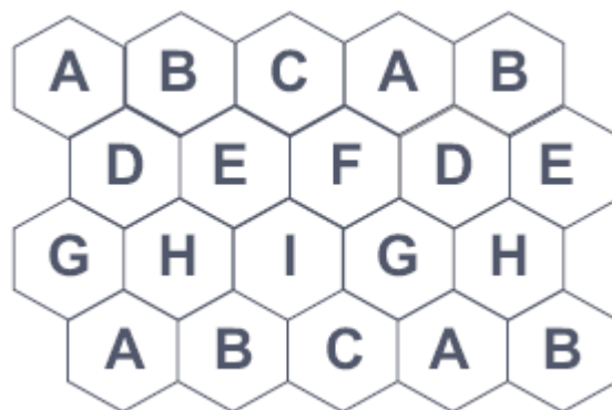
Figure V.21 – Organisation des cellules utilisant 9 jeux de fréquence de base.
