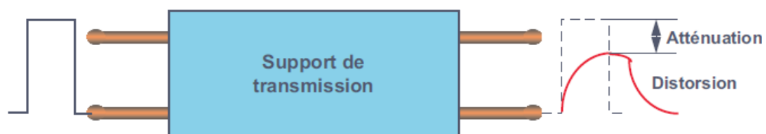
Figure II.2 – Déformation du signal par le support de transmission.
