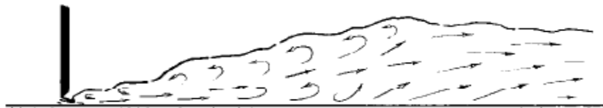
Cas Fr > 9 : ressaut fort avec surface d'eau avale rugueuse.
