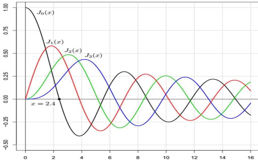
Figure.2. Fonctions de Bessel  $J_n(\beta)$ ,  $n = 1, 2, 3, 4$
