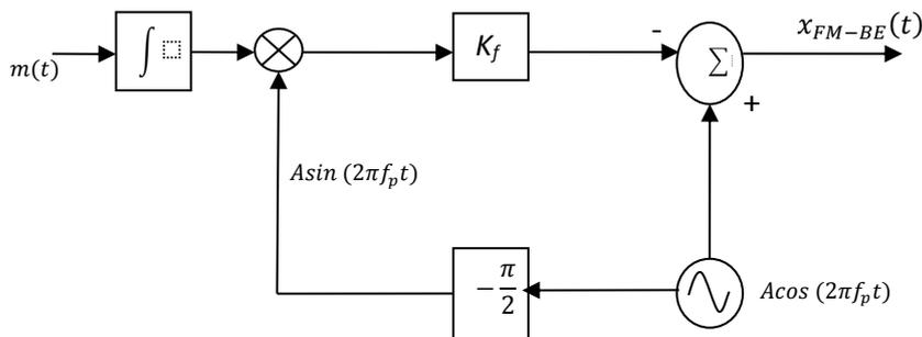
Figure.5. Modulation FM bande étroite
