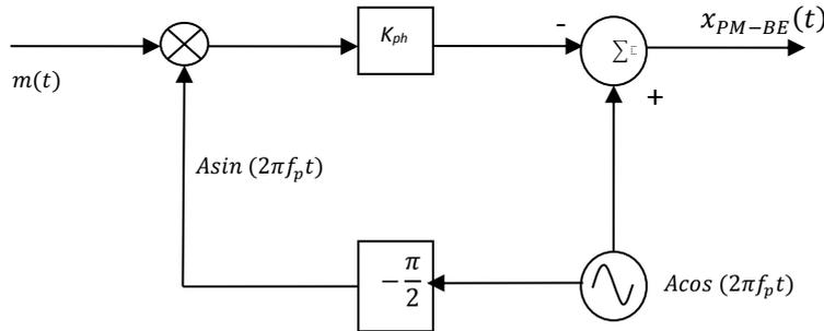
Figure.4. Modulation PM bande étroite
