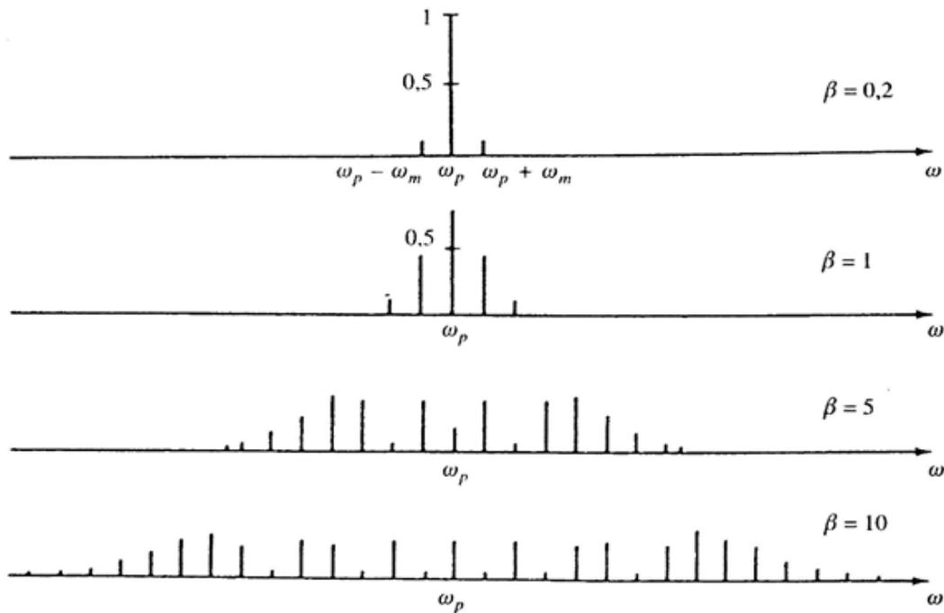
Figure.3. Spectre d'une onde modulée en fréquence par un signal sinusoïdal pur de fréquence  $f_m$  fixe
