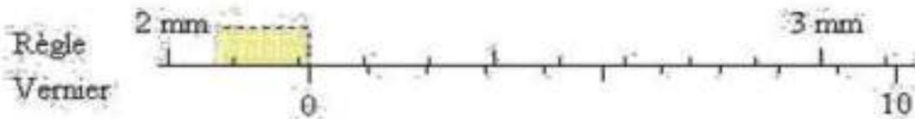
Dans cet exemple, aucun trait du vernier ne coïncide parfaitement. Néanmoins, la 2<sup>e</sup> et la 3<sup>e</sup> division sont assez près d'un trait de la règle. La longueur à mesurer est alors supérieure à 2,2 mm, mais inférieure à 2,3 mm; l'on dira  $2,35 \text{ mm} \pm 0,05 \text{ mm}$ .
