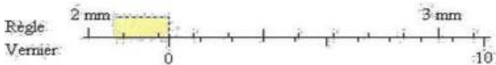
Dans cet exemple, la 3<sup>e</sup> division du vernier coïncide avec un trait de la règle. La mesure est donc  $2,3 \text{ mm} \pm 0,1 \text{ mm}$ .
