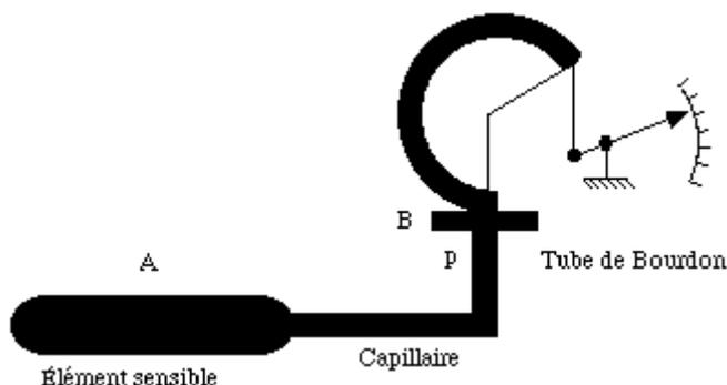
Sous l'effet de la température du milieu dans lequel la sonde est placée, la pression du gaz va varier, ce qui modifiera l'équilibre de l'extrémité libre du tube de Bourdon. Cette variation de pression se traduira par un mouvement de rotation de l'index indicateur qui se déplacera devant un cadran portant des graduations thermométriques.
