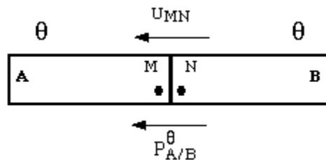
À la jonction de deux conducteurs A et B différents mais à la même température  $\theta$ , s'établit une différence de potentiel qui ne dépend que de la nature des conducteurs et de leur température  $\theta$ .
