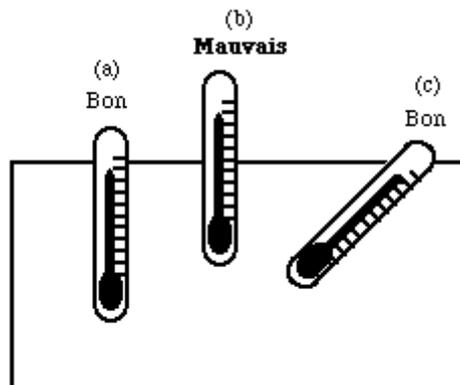
Dans ce cas on doit penser à corriger la mesure de la température s'il est impossible d'immerger complètement la colonne. Dans les cas (a) et (c) la colonne de liquide thermométrique est totalement immergée dans l'enceinte dont on mesure la température X. La dilatation de ce liquide se fait donc pleinement. Dans le cas (b) une partie de la colonne de liquide est en contact avec la température ambiante. Le volume correspondant dépend donc de la résultante de ces deux températures.
