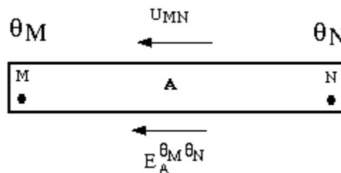
Entre deux points M et N à température différente, à l'intérieur d'un conducteur homogène A s'établit une force électromotrice, ne dépendant que de la nature du conducteur et des températures  $\theta_M$  et  $\theta_N$  :
