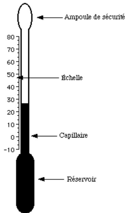
Il est réalisé en verre et est constitué d'un réservoir surmonté d'un capillaire de section faible et régulière (ordre de grandeur : Diamètre = 0,2 mm) se terminant par une ampoule de sécurité (utile lors d'un dépassement de la température admissible). Sous l'effet des variations de température, le liquide se dilate plus ou moins. Son niveau est repéré à l'aide d'une échelle thermométrique gravée sur l'enveloppe.
