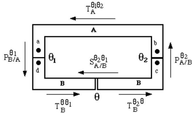
Soit un circuit fermé, constitué de deux conducteurs A et B dont les jonctions sont à des températures  $\theta_1$  et  $\theta_2$ . Ce circuit constitue un couple thermoélectrique. Ce couple est le siège d'une force électromotrice dite de Seebeck qui résulte des effets de Peltier et de Thomson qui s'y produisent.
