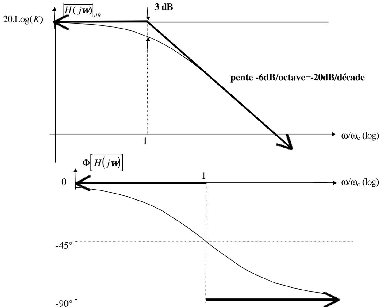
Le système possède une fréquence de coupure pour  $\omega_c = 1/t$
