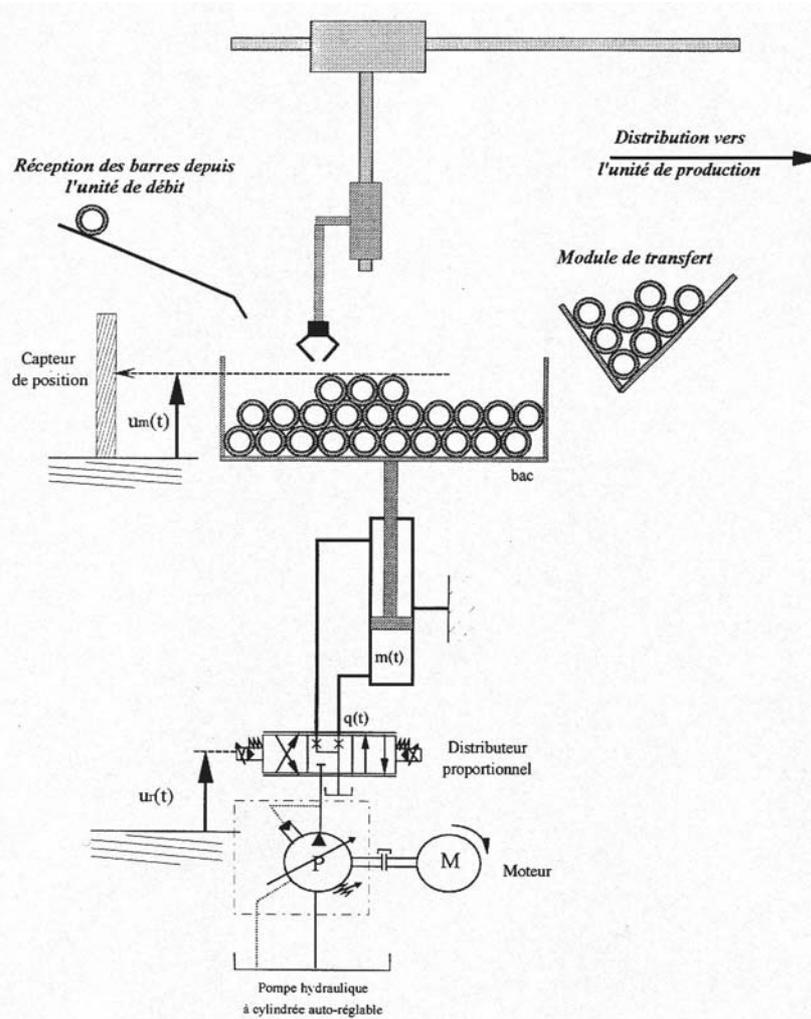
automatique de tubes de diamètres compris entre 10 et 60 mm et de longueur comprise entre 200 et 1200 mm. L'altitude des barres dans le bac est asservie grâce à un vérin hydraulique associé à un électro-distributeur à commande proportionnelle. Le capteur de position est analogique.
