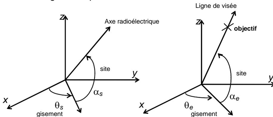
Des capteurs de positions permettent d'avoir en permanence une image  $\theta_s$  et  $\alpha_s$ . En présence d'une cible réfléchissante, l'écho reçu par la parabole dépend du « dépointage angulaire » entre l'axe radioélectrique et la ligne de visée. Le dispositif radar est capable de délivrer deux tensions proportionnelles aux écarts angulaires  $(\theta_e - \theta_s)$  et  $(\alpha_e - \alpha_s)$ .
