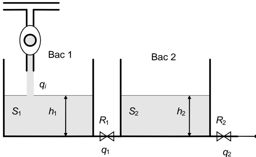
On considère le système ci-dessus. Le débit de chaque vanne est linéaire et supposé proportionnel à la hauteur de liquide  $q = h/R$ . Les surfaces de chaque bac sont notées respectivement  $S_1$  et  $S_2$ . Le bac 1 est alimenté par un débit  $q_i(t)$ .
