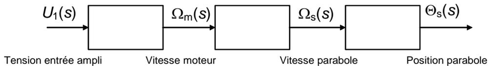
2 – On envisage le fonctionnement du système en asservissement, ce qui conduit au schéma fonctionnel de la figure ci-dessous :
