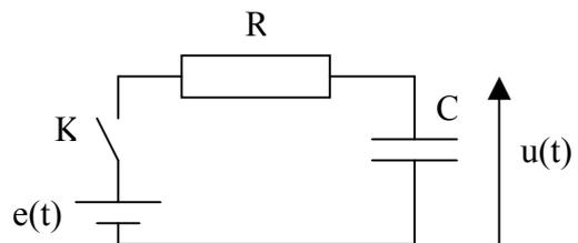
On veut déterminer l'allure de la tension de sortie en passant par la représentation de Laplace
