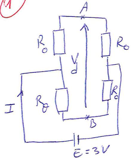
b/ la tension  $V_d$  :  $V_d = V_A - V_B$
