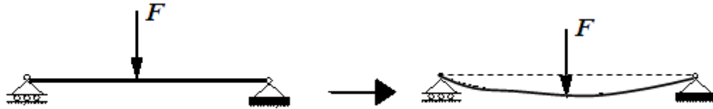
Fig. 6.2- Courbure d'une poutre.
