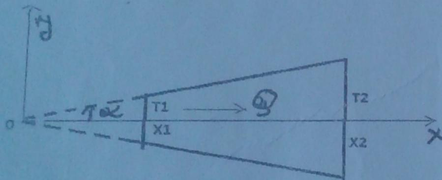
Soient  $T_1$  et  $T_2$  les températures des faces extrêmes (on suppose  $T_1 > T_2$ ),  $K_m$  la conductivité moyenne du solide, calculer la quantité de chaleur  $Q$  qui traverse le solide par unité de temps.
