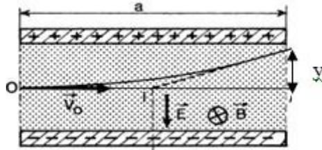
Dans l'expérience de J.J. Thomson, on réalise la déviation d'un faisceau d'électrons à l'aide d'un champ électrique E et on mesure la déviation Y sur l'écran. La déviation du faisceau électronique est annulée par l'action antagoniste d'un champ magnétique B qui agit dans le même espace que E.
