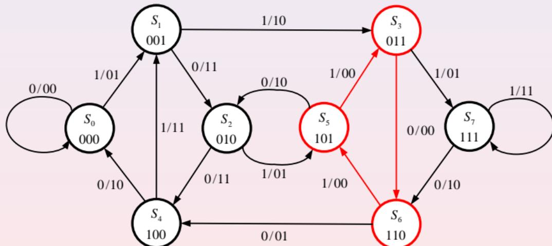
Donc, le nombre fini d'erreurs causées par le canal (deux erreurs de transmission) se traduit par un nombre infini (potentiellement) d'erreurs dans la séquence d'information décodée. Le codeur convolutif est donc un codeur catastrophique.
