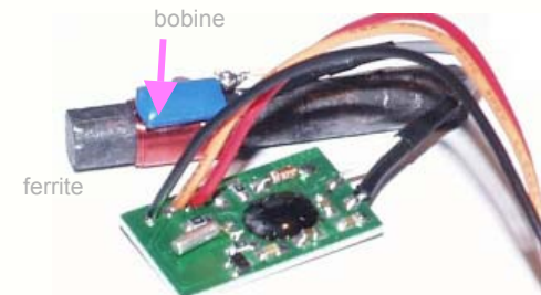
Récepteur de signaux horaires DCF à 77 kHz
