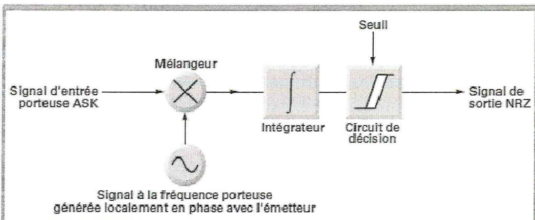
4-Par principe, le démodulateur cohérent nécessite la présence d'un oscillateur local verrouillé en fréquence et en phase sur le signal reçu. L'oscillateur local et le signal reçu sont multipliés dans un mélangeur. Le résultat de la multiplication est intégré et envoyé au circuit de décision. Le circuit de décision est un comparateur à seuil.
