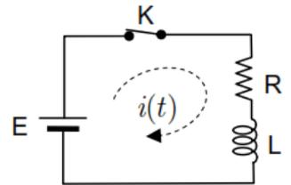
2. Considérer le circuit de la figure ci-contre. L'interrupteur K est en position 1. Le circuit est en régime permanent. A l'instant  $t = 0$ , on bascule K sur la position 2. En utilisant les transformées de Laplace, donner l'évolution du courant  $i(t)$  en calculant son expression.
