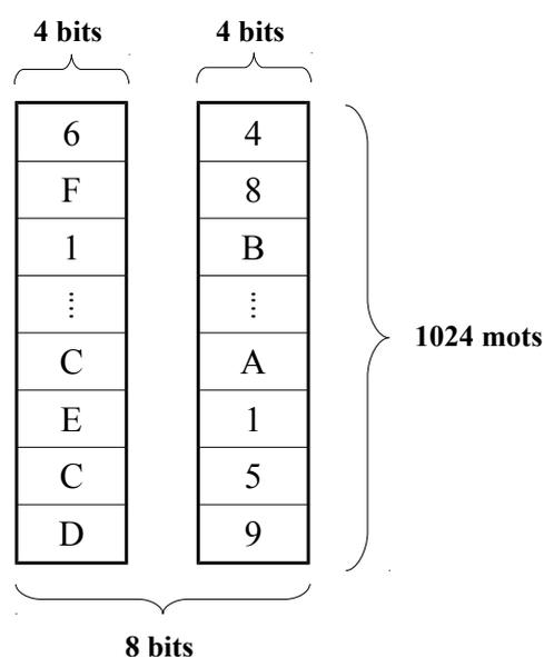
On peut très bien imaginer que ces deux mémoires d'une largeur de 4 bits par mot ne forment en fait qu'une seule mémoire d'une largeur de 8 bits par mot. Pour arriver à ce résultat, il faut câbler les mémoires de la façon suivante :
