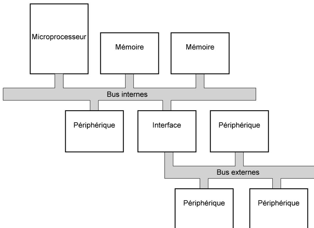
Un bus est un ensemble de fils qui sert à faire circuler des informations entre les différents composants d'un ordinateur. Par exemple, un bus de huit fils pourra transférer des données codées sur 8 bits.
