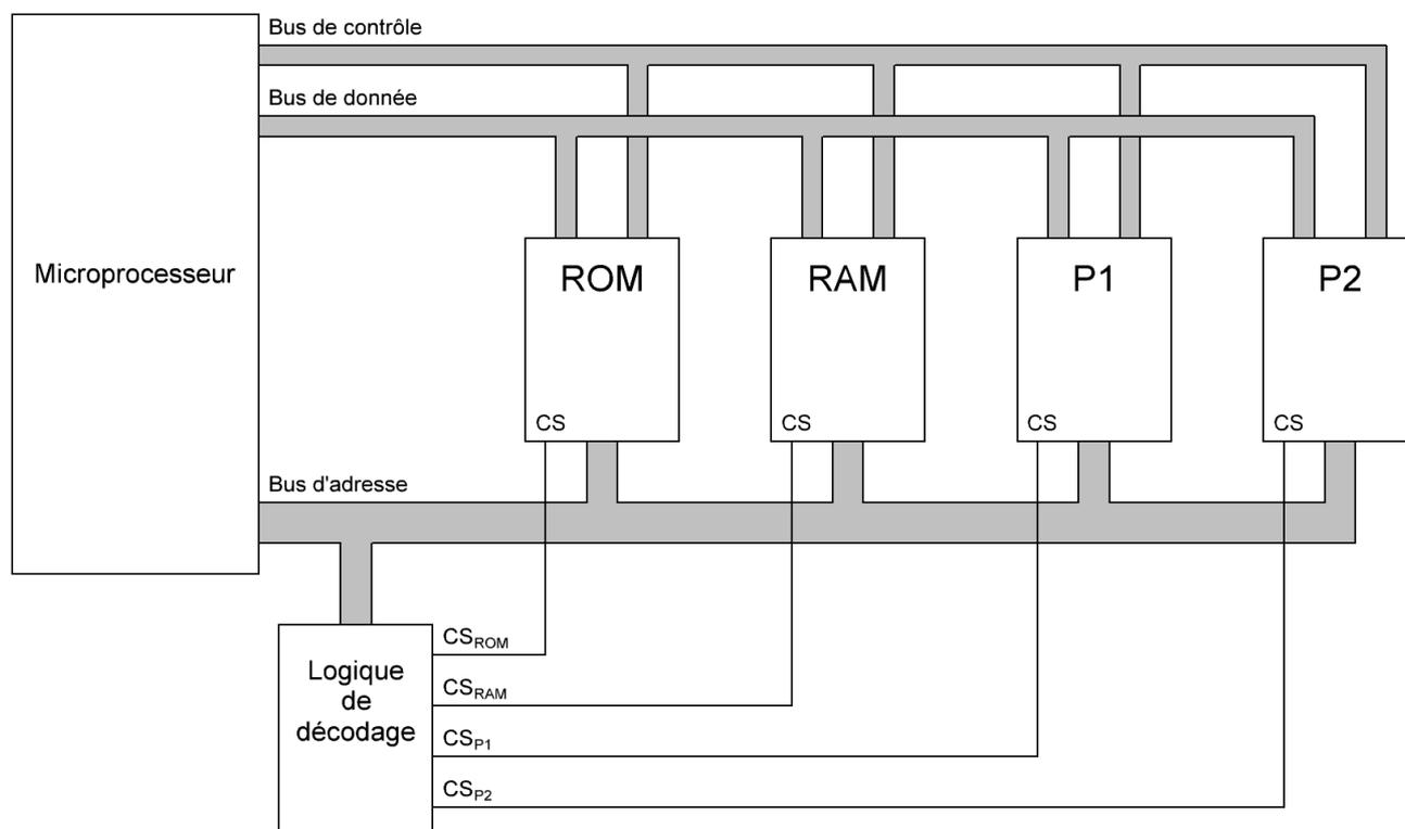
Tous les composants souhaitant échanger des informations avec le microprocesseur et accéder aux différents bus doivent posséder une entrée d'activation **CS** (*Chip Select*). En effet, un seul composant à la fois doit accéder aux bus. Si plusieurs composants accèdent aux bus en même temps, cela produira un conflit d'accès.
