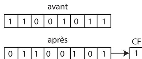
→ entrée d'un 0 à la place du bit de poids fort ; le bit sortant passe à travers l'indicateur de retenue CF.
