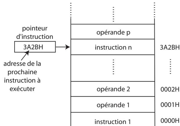
**Remarque** : la valeur initiale du pointeur d'instruction est fixée par le constructeur du microprocesseur. Elle vaut une valeur bien définie à chaque mise sous tension du microprocesseur ou bien lors d'une remise à zéro (reset).
