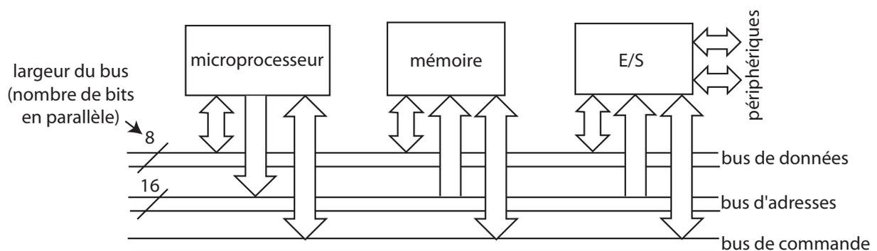
**Remarque** : les bus de données et de commande sont **bidirectionnels**, le bus d'adresse est **unidirectionnel** : seul le microprocesseur peut délivrer des adresses (il existe une dérogation pour les circuits d'accès direct à la mémoire, DMA).
