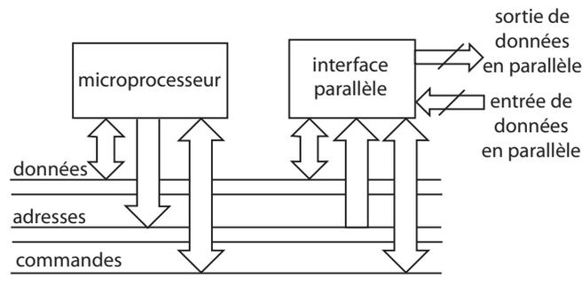
Le 8255 est une interface parallèle programmable : elle peut être configurée en entrée et/ou en sortie par programme.
