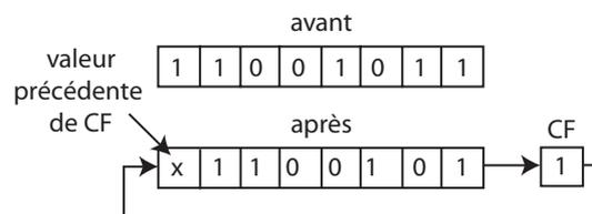
→ le bit sortant par la droite est copié dans l'indicateur de retenue CF et la valeur précédente de CF est réinjectée par la gauche.
