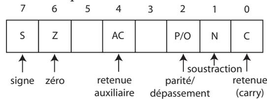
Les indicateurs d'état sont activés lorsqu'une certaine condition est remplie, exemple : le flag Z est mis à 1 lorsque la dernière opération a donné un résultat nul, le flag C est mis à un lorsque le résultat d'une addition possède une retenue, ...
