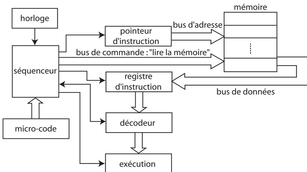
Pour exécuter le programme contenu dans la mémoire centrale, le séquenceur du microprocesseur exécute lui-même un programme appelé **micro-code**, contenu dans une mémoire morte à l'intérieur du microprocesseur.
