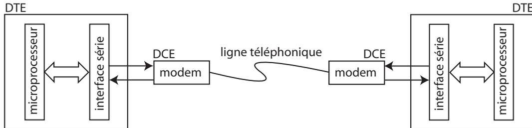
Le modem transforme les signaux numériques produits par l'interface série en signaux analogiques acceptés par la ligne téléphonique et inversement (modulations numériques FSK, PSK, ...)
