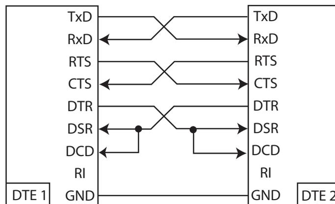
Ce câblage simule la présence d'un modem (DCE) en croisant les signaux de contrôle et permet le contrôle matériel du flux.
