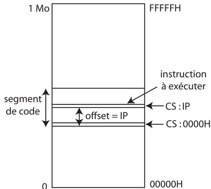
De même, les registres de segments DS et ES peuvent être associés à un registre d'index. Exemple : DS : SI, ES : DI. Le registre de segment de pile peut être associé aux registres de pointeurs : SS : SP ou SS : BP.
