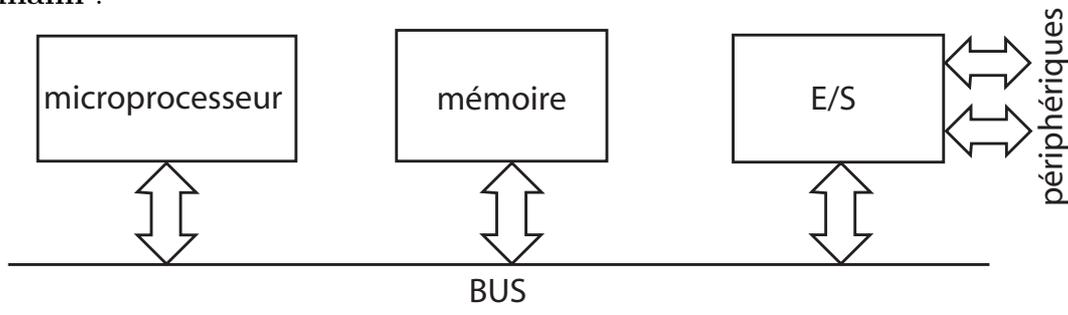
Le microprocesseur échange des informations avec la mémoire et l'unité d'E/S, sous forme de mots binaires, au moyen d'un ensemble de connexions appelé **bus**. Un bus permet de transférer des données sous forme **parallèle**, c'est-à-dire en faisant circuler  $n$  bits simultanément.
