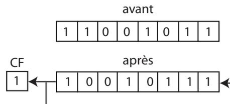
→ réinjection du bit sortant qui est copié dans l'indicateur de retenue CF.
