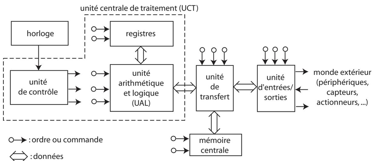
L'élément de base d'un ordinateur est constitué par l'**unité centrale de traitement** (UCT, CPU : Central Processing Unit). L'UCT est constituée :
