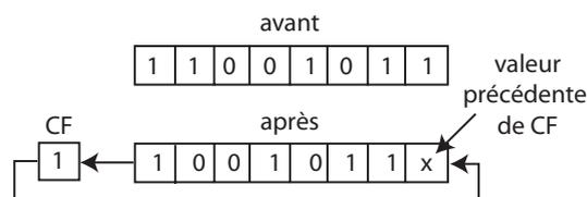
→ le bit sortant par la gauche est copié dans l'indicateur de retenue CF et la valeur précédente de CF est réinjectée par la droite.
