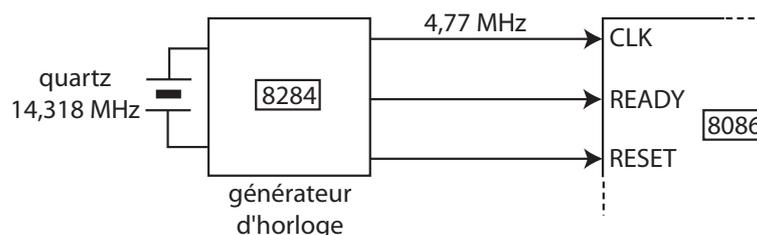
**RESET** : entrée de remise à zéro du microprocesseur. Lorsque cette entrée est mise à l'état haut pendant au moins 4 périodes d'horloge, le microprocesseur est réinitialisé : il va exécuter l'instruction se trouvant à l'adresse FFFF0H (adresse de bootstrap). Le signal de RESET est fourni par le générateur d'horloge.
