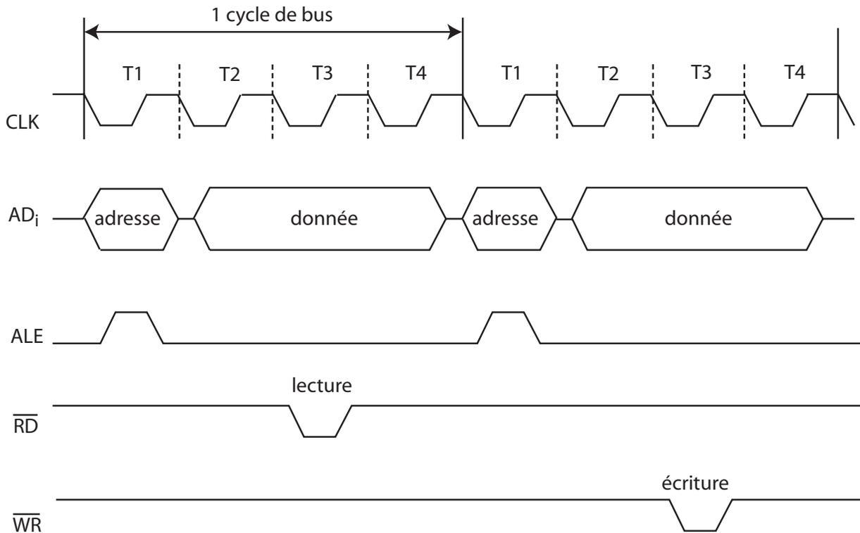
Le démultiplexage des signaux  $AD_0$  à  $AD_{15}$  (ou  $A_{16}/S_3$  à  $A_{19}/S_6$ ) se fait en mémorisant l'adresse lorsque celle-ci est présente sur le bus A/D, à l'aide d'un **verrou** (latch), ensemble de bascules D. La commande de mémorisation de l'adresse est générée par le microprocesseur : c'est le signal **ALE**, Address Latch Enable.
