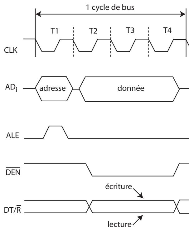
Les signaux  $\overline{DEN}$  et  $DT/\overline{R}$  sont utilisés pour la commande de **tampons de bus** (buffers) permettant d'amplifier le courant fourni par le microprocesseur sur le bus de données.
