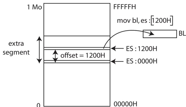
**Remarque** : dans le cas de l'adressage immédiat de la mémoire, il faut indiquer le **format** de la donnée : octet ou mot (2 octets) car le microprocesseur 8086 peut manipuler des données sur 8 bits ou 16 bits. Pour cela, on doit utiliser un **spécificateur de format** :
