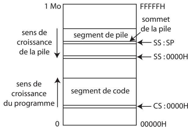
**Remarque :** la pile et le programme croissent en sens inverse pour diminuer le risque de collision entre le code et la pile dans le cas où celle-ci est placée dans le même segment que le code (SS = CS).
