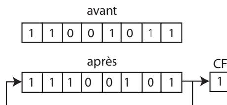
→ réinjection du bit sortant qui est copié dans l'indicateur de retenue CF.
