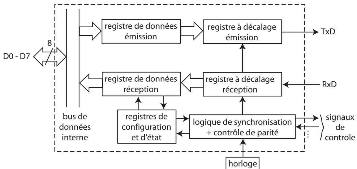
Un circuit intégré d'interface série asynchrone s'appelle un **UART** : Universal Asynchronous Receiver Transmitter); une interface série synchrone/asynchrone est un **USART**.
