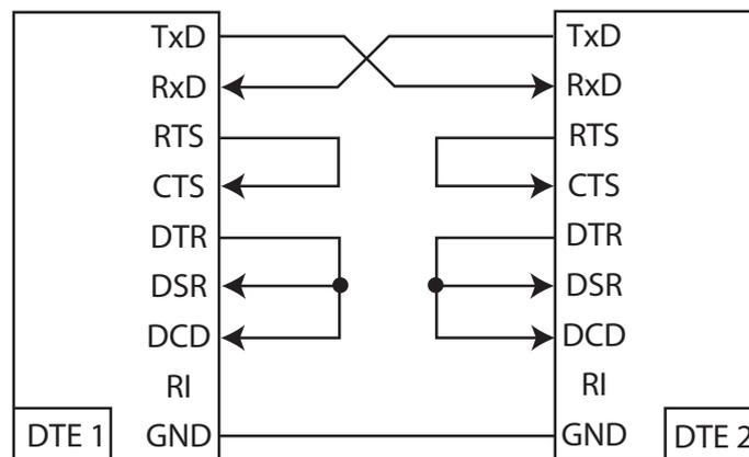
Ce câblage ne permet pas le contrôle matériel du flux entre les deux DTE.
