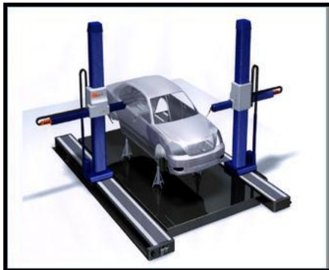
Contrôle de modèle de voiture sur une MMT
