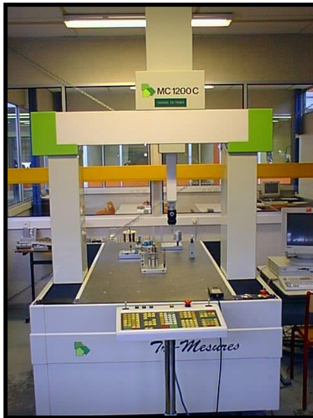
Contrôle de pièce sur une MMT
