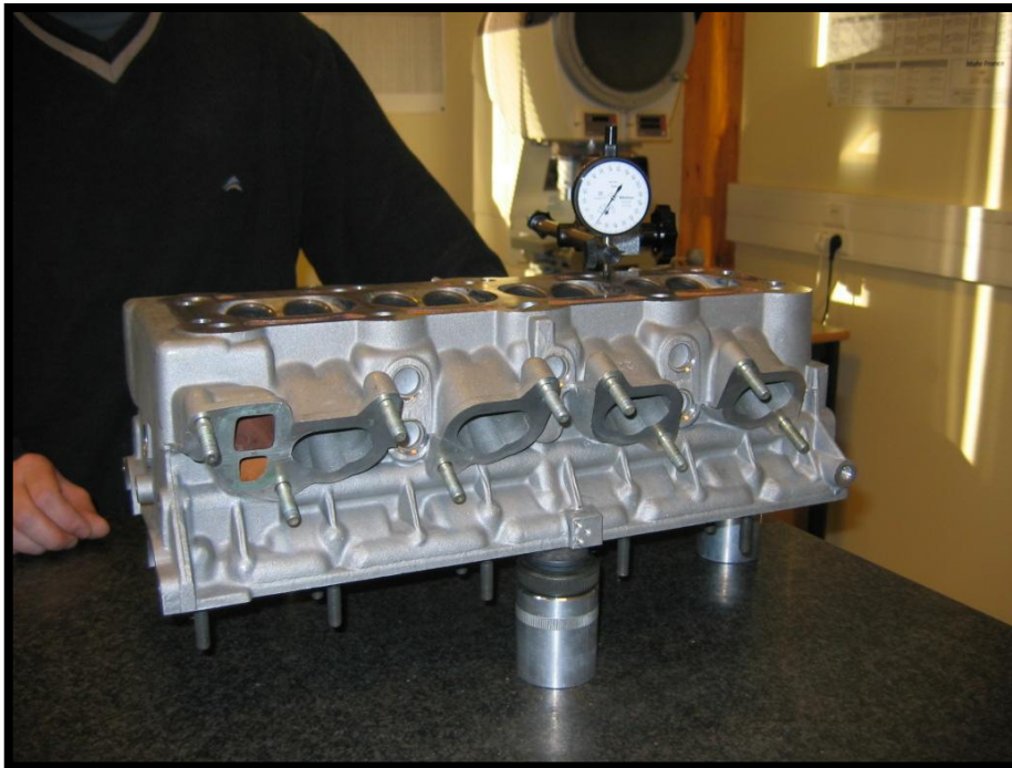
Contrôle de planéité d'une culasse de moteur thermique
