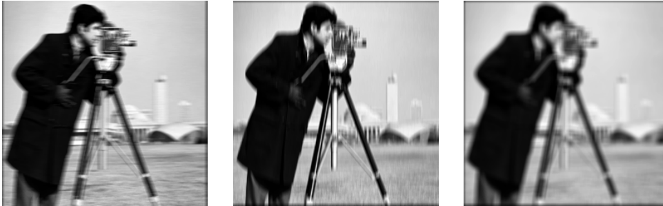
Figure 3: Filtrage passe-bas horizontal (à gauche), vertical (au centre) et isotrope (à droite).
