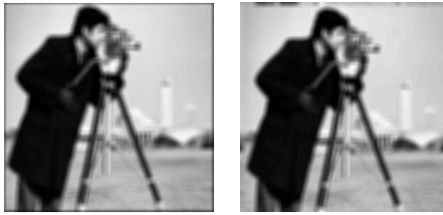
Figure 4: Filtrage isotrope par multiplication des transformées dans le domaine fréquentiel (à gauche) et par convolution (à droite).
