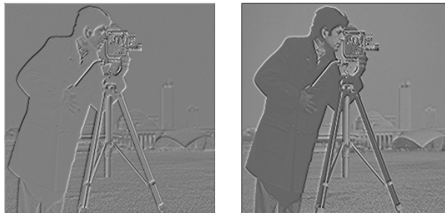
Figure 5: Détection des contours (à gauche) et rehaussement (à droite).
