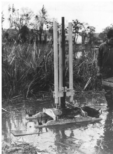
Figure 20 - Mise en œuvre du scissomètre à l'aide d'un bâti ancré
