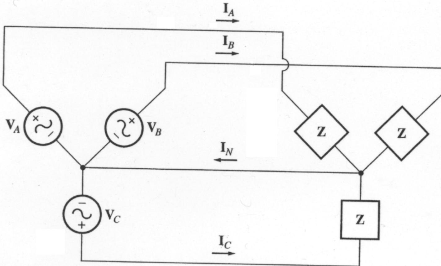
Les 3 circuits connectés ensemble avec une connexion neutre commune.
