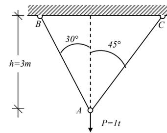
Le système ci-contre, constitué de deux câbles (AB et AC), est soumis à une force verticale P (les câbles sont de même nature et de même section).
