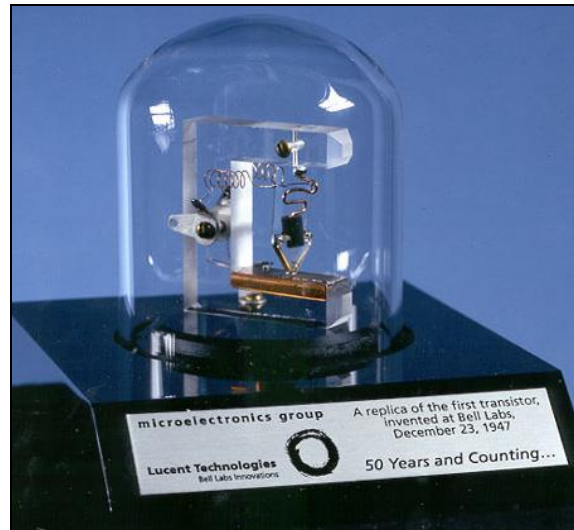
Figure 8 : Réplique du premier transistor bipolaire en germanium
