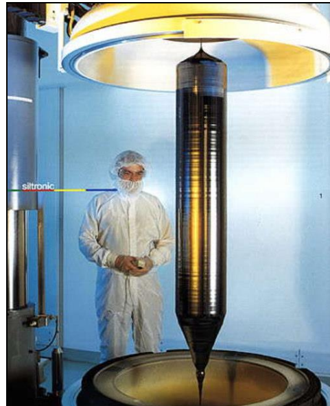
Figure 26 : Lingot monocristal de Si de 300mm de diamètre et de 1m de longueur.
