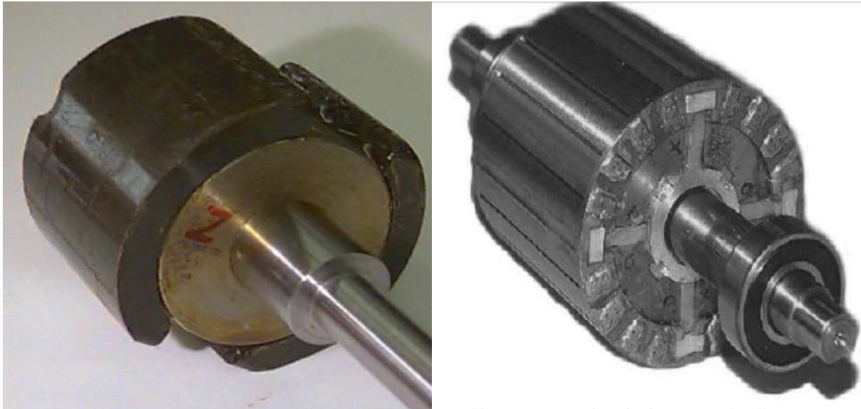
Figure II.5. Exemple de rotor à aimants permanents
