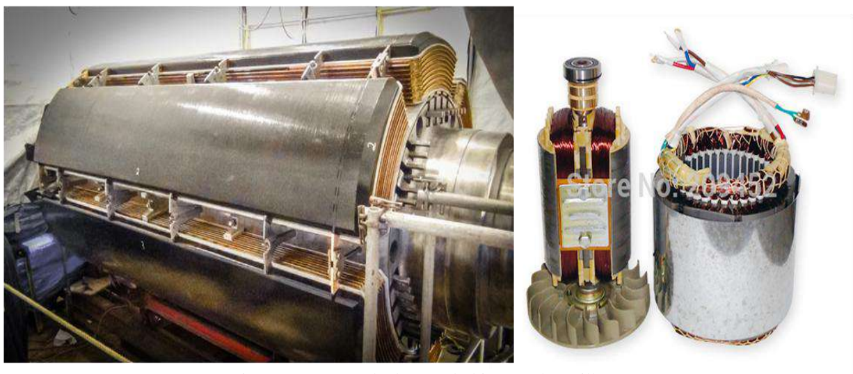
Figure II.4. Exemple de rotor bobiné à pôles saillants
