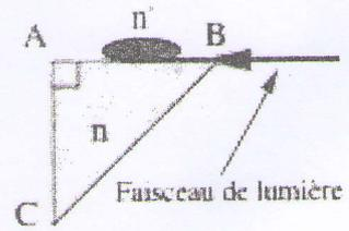
Sur la face AB, on pose une goutte de liquide d'indice  $n'$  et on envoie, sur elle et tangentiuellement à la face AB, un faisceau de lumière monochromatique puis, on mesure, par la face AC, l'angle d'émergence  $i_0$  des rayons lumineux dans l'air ( $n_{\text{air}}=1$ ).
