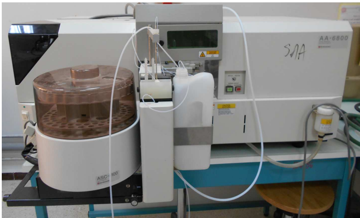
Fig.19. Photo d'un spectromètre d'absorption atomique de flamme (Shimadzu 6800) et équipé d'un four en graphite.
