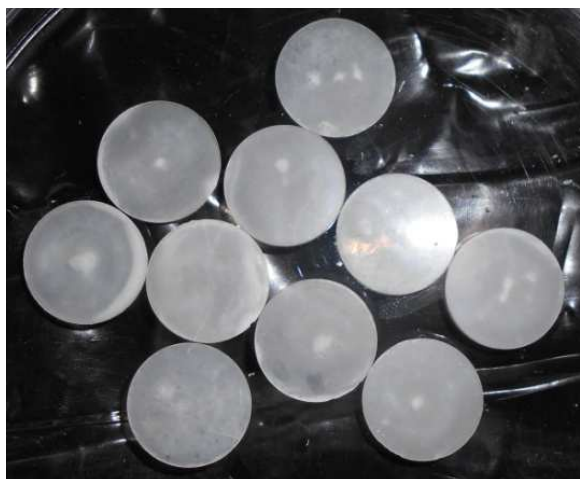
Fig.25. Pastilles de KBr pures.
