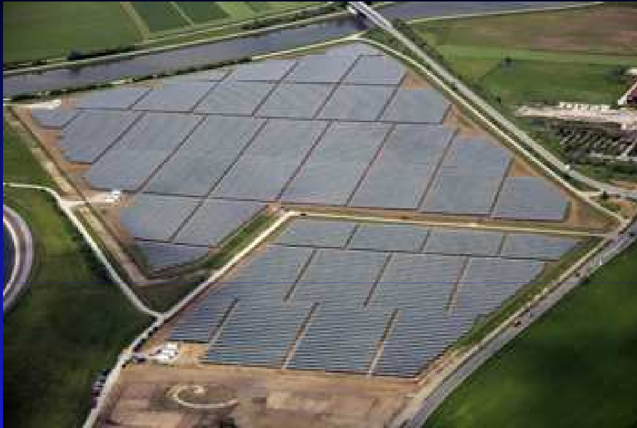
Centrale de Serpa (Portugal : 52 000 panneaux sur 60 hectares pour une puissance de 11 MW)
